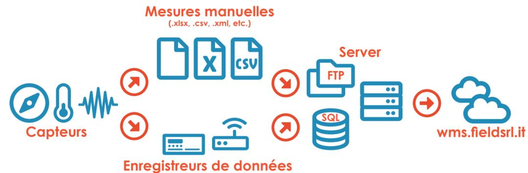
Vous pouvez définir jusqu'à **quatre types de seuils d'alerte** et configurer l'**envoi de messages** d'alarme par **SMS** et **e-mail** aux utilisateurs activés dans le cas où la mesure d'un outil dépasse l'un des seuils fixés.
